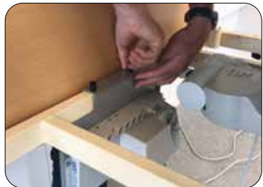
Fastgør kontrolenheden på sengerammen ved at stramme de to sorte fingerskruer
