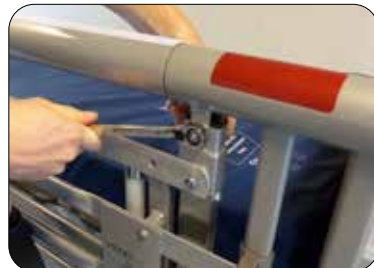
Monter igen møtrik og bolt
