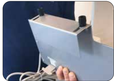
Løsn skruerne på ophængspladen til kontrolenheden
