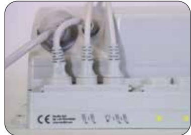
Håndbetjeningen tilsluttes kontrolenheden
