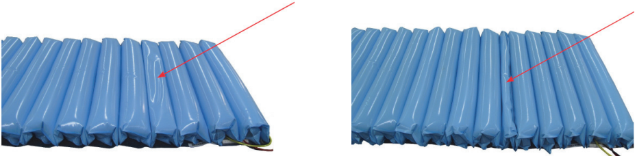
Esimerkkejä puhjenneista yläkennoista.
