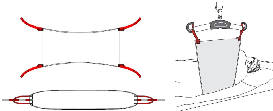
TurningSling är ett vändningshjälpmedel som kombineras tillsammans med en tvåpunktslyftbygel i tak-, eller mobillyft. Den är utformad för att ge stöd bakom ländryggen men lämna stussen fri för att underlätta rengöring och påklädnad. TurningSling har upphängningspunkter på varje sida. TurningSling är tillverkad av ett slitstarkt engångsmaterial som innebär att den inte är tvättbar utan kasseras när den blir smutsig eller då brukaren inte behöver hjälpmedlet längre.
