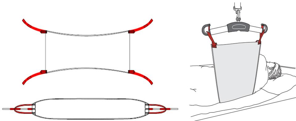
TurningSling er et hjælpemiddel til vending, som kombineres med et topkantsåg i en loft- eller mobiløfter. Den er udformet til at yde støtte bag lænderyggen, men samtidig holde bagdelen fri for at lette vask og påklædning. TurningSling har to ophængspunkter på hver side. TurningSling er fremstillet af et slidstærkt engangsmateriale, hvilket indebærer, at den ikke kan vaskes, men kasseres, når den bliver beskidt, eller når brugeren ikke har brug for hjælpemidlet længere.
