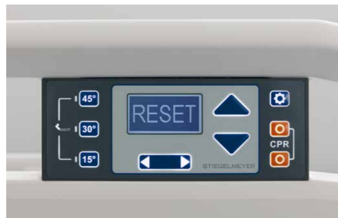
▲ Användarnivån för teknisk personal i LCD-handkontrollen och i manöverpanelen har praktiska inställningar för underhåll, felanalys och återställningsfunktioner.
