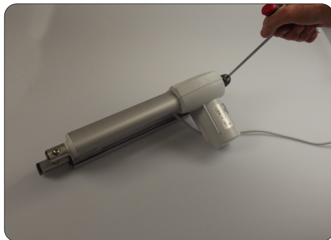
Verwijder inbusschroeven en koppel de aandrijfinrichting los
