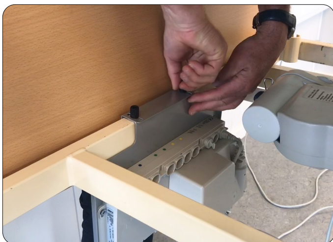
Fixeer de ophangbeugel door de 2 schroeven aan te draaien.
