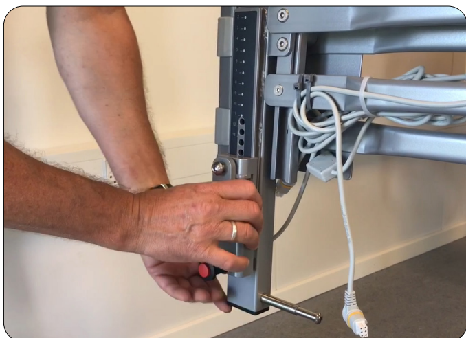
Schuif van onderen de montagebeugel op het VENDLET systeem
