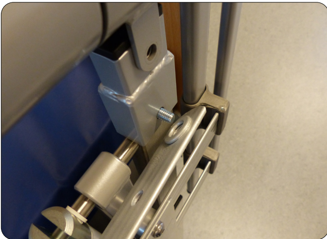
Plaats de bout met daarbij de dwarsstang.
