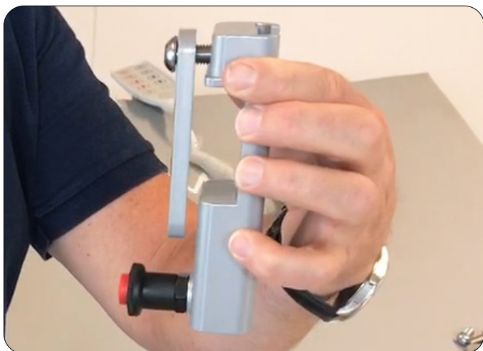
Schroef met de juiste M10 bout de montageplaat op de montagebeugel op elkaar
