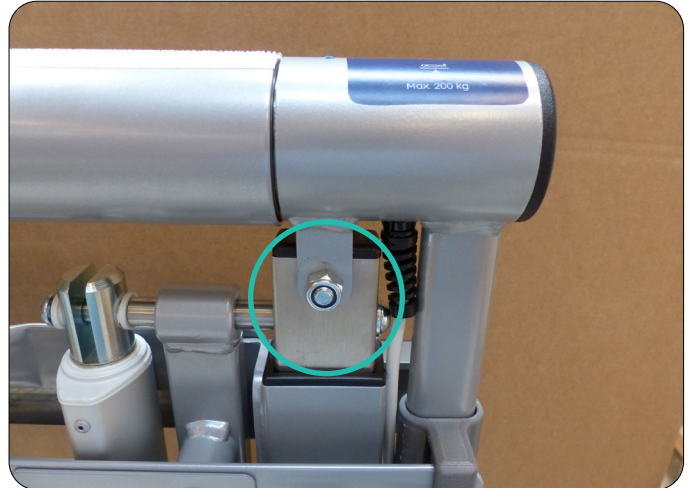
Demonteer de rolbuis van de draagarm voor de actuator
