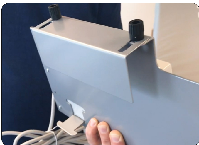
Draai de schroeven op de ophangbeugel los
