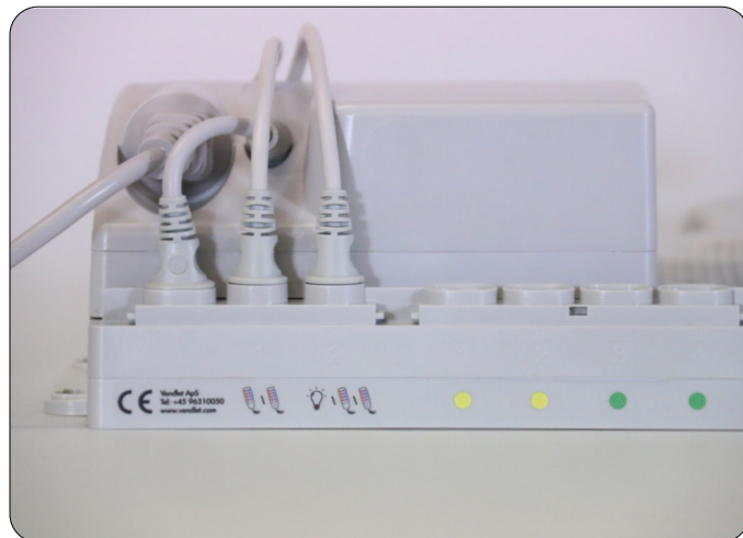
Sluit de handbediening aan op de besturingseenheid.
