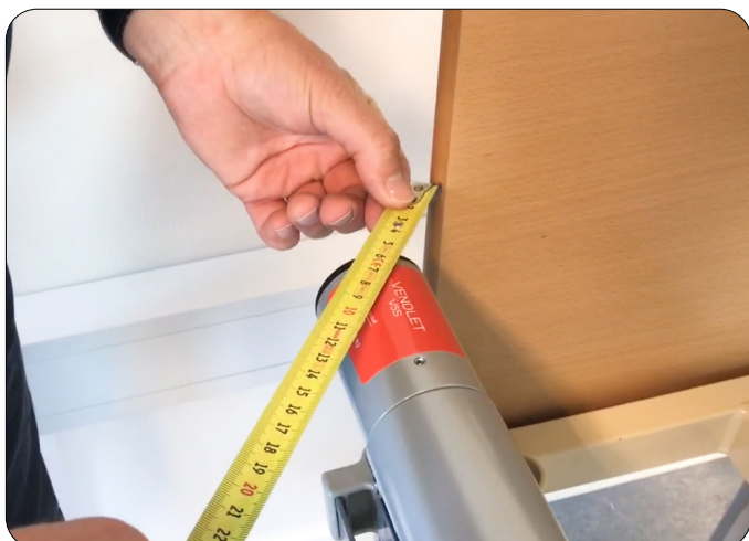
Pas de positie van het VENDLET systeem op het bedframe aan zodat er een afstand van max. 6 cm is tussen het VENDLET systeem en het hoofd- en voeteneinde
