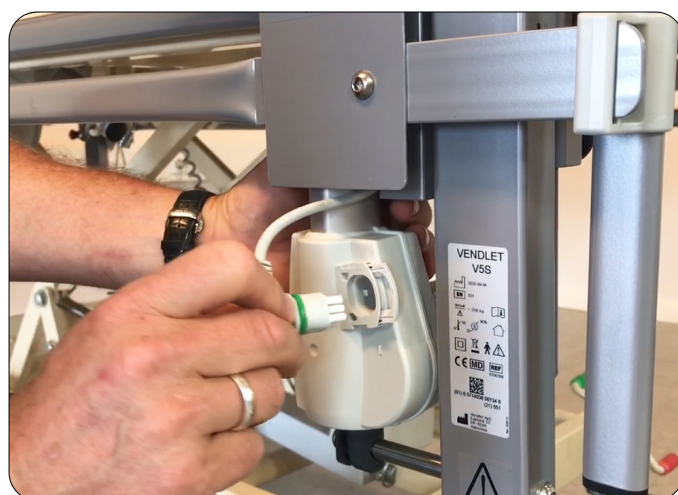
Sluit de connector aan op de behuizing van de actuator
